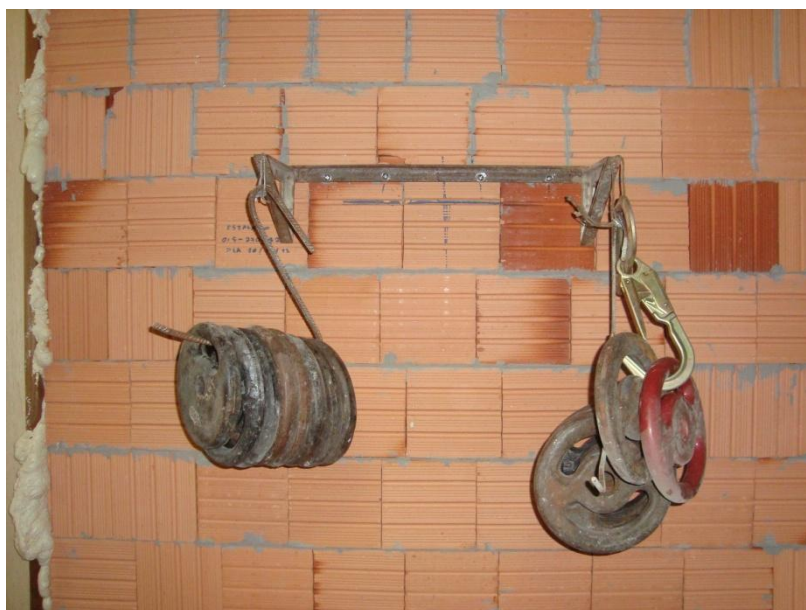
Foto 04 – Ensaio de capacidade de suporte de peças suspensas
