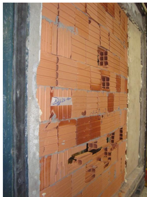
Foto 02 – Protótipo após o impacto
