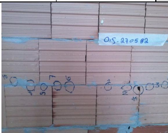
Foto 03 – Protótipo após o impacto
